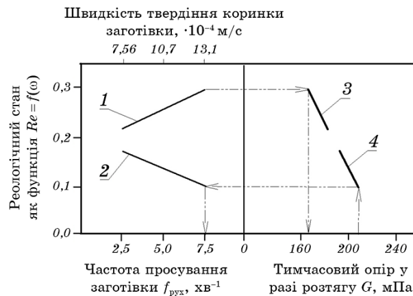
Рис. 8. Вплив технологічного параметра f_{\text{рух}} та напрямку руху заготовки на реологічні \omega і механічні \sigma_{\text{тчас}} властивості заготовки [15]: 1, 2 — залежності f_{\text{рух}}-\omega для поступального і реверсивного рухів заготовки під час подолання сили тертя спокою відповідно; 3, 4 — залежності \omega-\sigma_{\text{тчас}} для поступального і реверсивного рухів заготовки відповідно.
